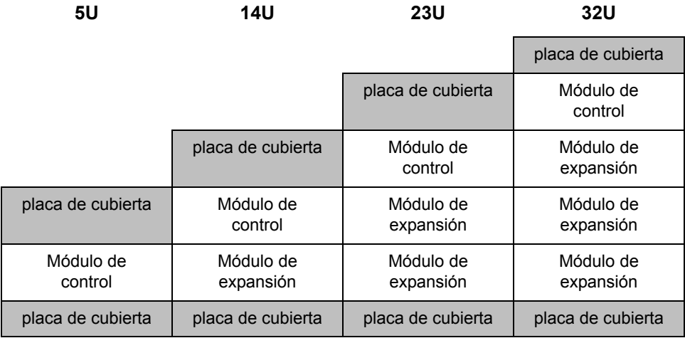
Figura 30 Ubicación de la placa de cubierta después de desmontar un módulo de expansión
