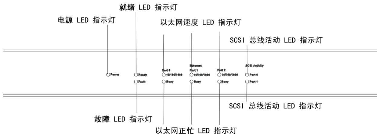
图 11 SNC 4500 正面的 LED 指示灯
